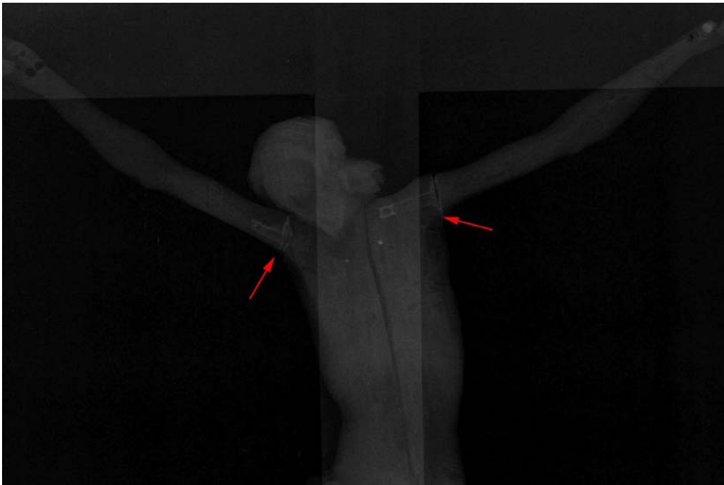
Abb. 3: Röntgenaufnahme zeigt die Dübelverbindungen der Arme
